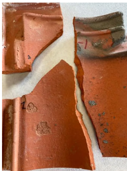
Fig. 8. Tagsten FMF3.1, efter genbrænding. Overfladeskader vurderes at være opstået i forbindelse med formgivningen – der er ikke tale om forvittringer.
