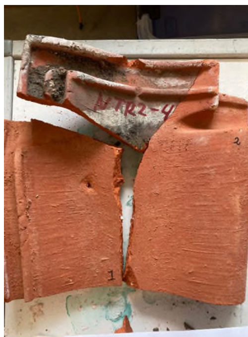
Fig. 6. Samme tagsten NTR2.4 efter genbrænding. Al biologisk vækst er bortbrændt. "Krateret" vurderes at være en enkeltstående kalkspringer og uden betydning for holdbarheden.
