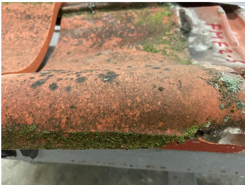
Fig. 3. Foto af tagsten FMF2.5, små "afskalninger" fra algelag
