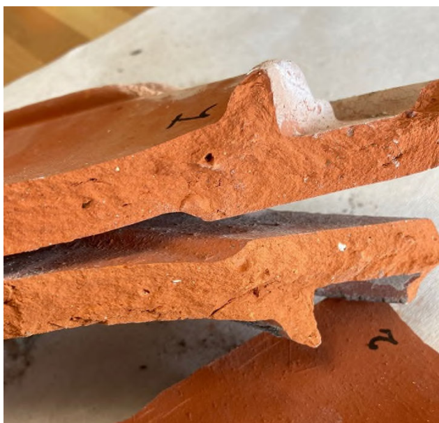
Fig. 4. Skærv fra NG2-3. Nederst ses skærven før genbrænding, øverst efter genbrænding til 980°C.
